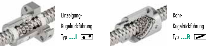
Kugelrückführungen (Details > Seite 9)
