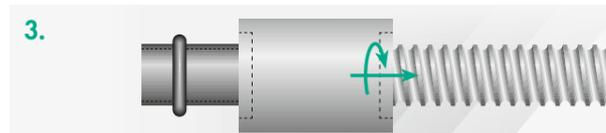
Mutter ohne Kraftaufwendung auf die Gewindespindel aufdrehen.
